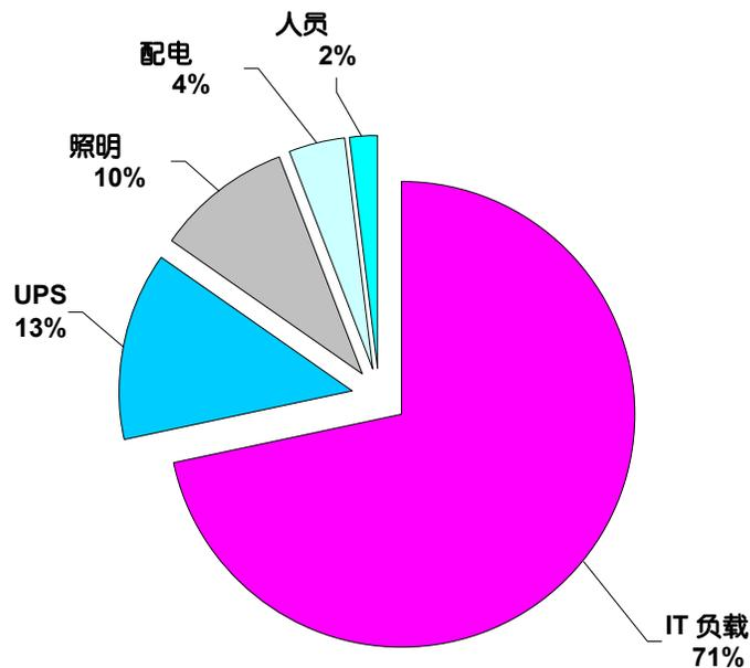
值得注意的是，由于系统仅工作在最大功率的 30%，所以对 UPS 和配电系统在总发热量中所占比例的估计要高于其实际值。如果系统以满负荷运转，电源系统的效率将提高，它在整个系统发热量中所占的比例将降低。如果对系统进行过度规划，那么将付出效率大幅降低的高昂代价。
