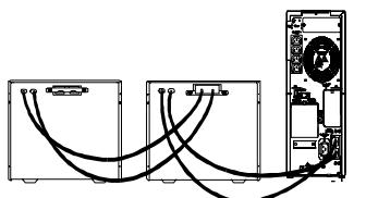
UXI 型不间断电源安装两个电池组的正确安装方法。
