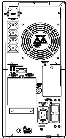
SU5000UXI 型不间断电源不带内置电池组。不间断电源外置电池组的接线端子位置请参见左图。电池组上的接线端子用不同的颜色加以区别：48Vdc UXBP48M 型电池组的接线端子为蓝色。为防止接线错误，电池组的接线端子亦有识别标号。
