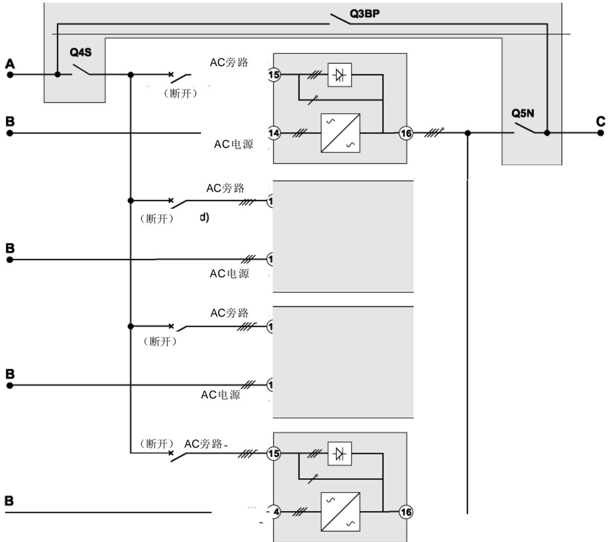
连接旁路交流输入端/输出端和外部旁路机柜的电缆长度和尺寸必须相同以确保旁路交流输入端电流正确平衡。
