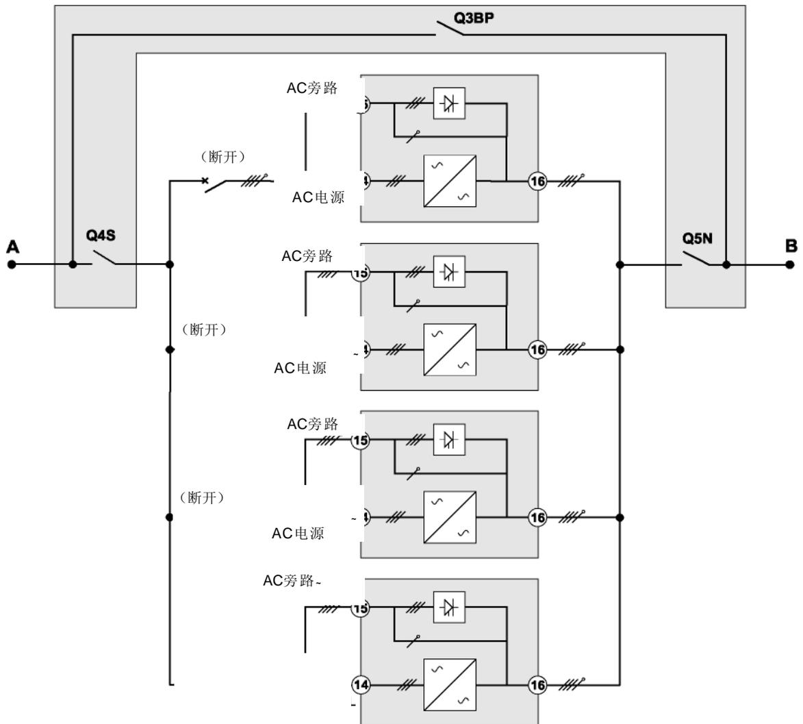
要求对输入端/输出端到外部旁路机柜之间的电缆进行星形连接，每台UPS的电缆长度和尺寸一样。
