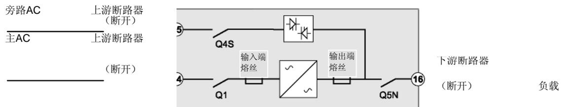
在确定上游断路器的规格时，必须考虑以下参数：UPS输入端及输出端熔丝的时间/电流曲线：
