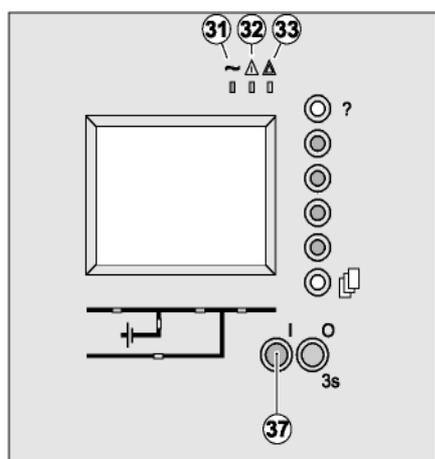
UPS机组自动启动。每一台机组上，LED指示灯（32）和（33）灭，LED指示灯（31）亮。
