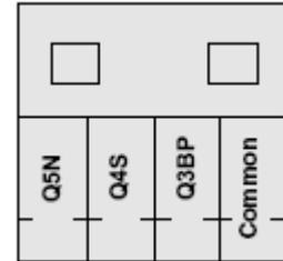
**注:** 外部旁路柜的连接电缆未受电（尺寸最大为2.5 mm<sup>2</sup>）。
