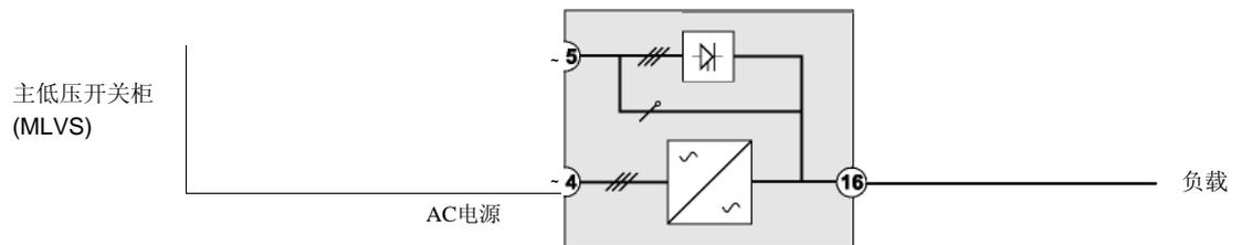
并机配置（最多并行配置两台机组），未配有外部旁路柜，主电源和旁路电源配有公共的输入接线端子
