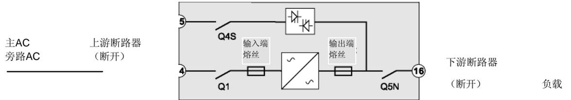
主电源和旁路电源具有分离输入接线端子的UPS机组
