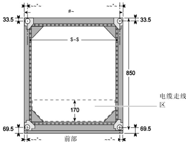
机柜四个地脚为圆柱形，直径40mm。
